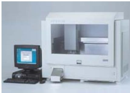
Plasmid DNA, genomic DNA の自動抽出機です。磁性ビーズを使用した核酸抽出キットを用いて、最大 48 サンプルを自動で処理できます。
